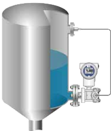
Pomiar różnicy ciśnień w separatorze membranowym spawanym do przyłącza (+) i na kapilarze (-).
